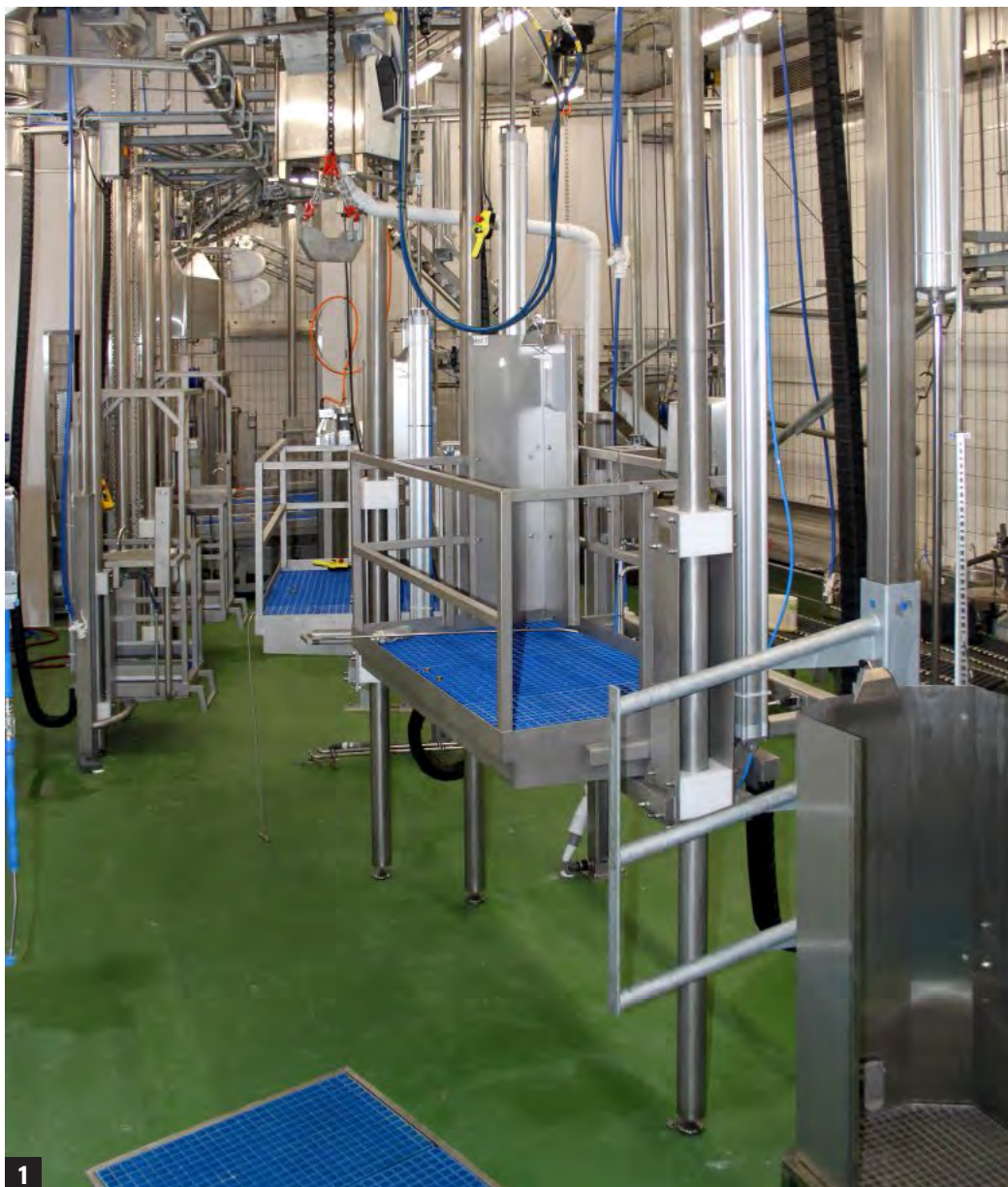
1 Die Schlachträume sind mit moderner Schlachthaus-technik und sieben Hubarbeitsbühnen ausgestattet, die den Mitarbeitern nun eine hängende Schlachtung ermöglichen. Die Rohrbahn und die Geräte wie Sägen oder Sterilisationskammern hängen von der sechs Meter hohen Decke ab.
